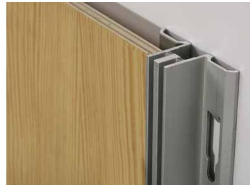
**CG grupa** elemenata smišljena je prvenstveno za gipskartonske plo e standardne debljine. Nosa i se skraju vijcima za limenu potkonstrukciju gipskartonskog zida, a plo e se na vertikalne nosa e spajaju uobi ajeno, vidljivim vijcima koji se sakriju gletanjem. Ovaj sustav upotpunjjen je podložnim trakama i zaštitnom brtvom za ute pri gletanju.
