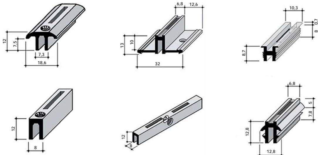
**HORIZONTAL grupa** elemenata sastoje se od profila ugrađenog između ploča i zidne obloge u koji se jednostavnim zahvatom umetnu držač polica, vješalice i sl. U ovom slučaju moguće je kontinuirani pomak po širini nosača. Kraji profila, duljine 50 mm, moguće je ugraditi u sredini ploče obloge i tako postići efekt točkastog nosača. Naravno, posebnim kapicama zatvaraju se polukružni završeci glodanog otvora.
